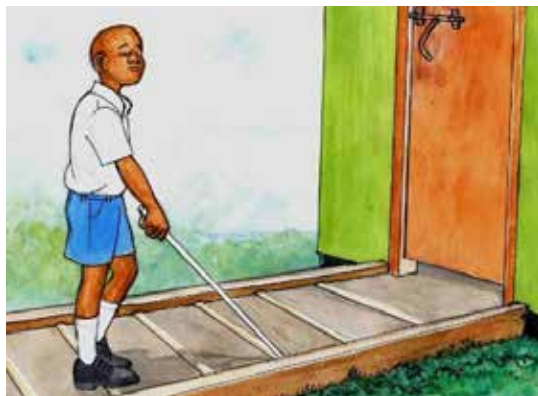
Ilustración 18: Niño ingresando al servicio sanitario, el piso incluye tiras táctiles en el camino y bordes de seguridad. (Fuente: Gobierno de Tanzania)
