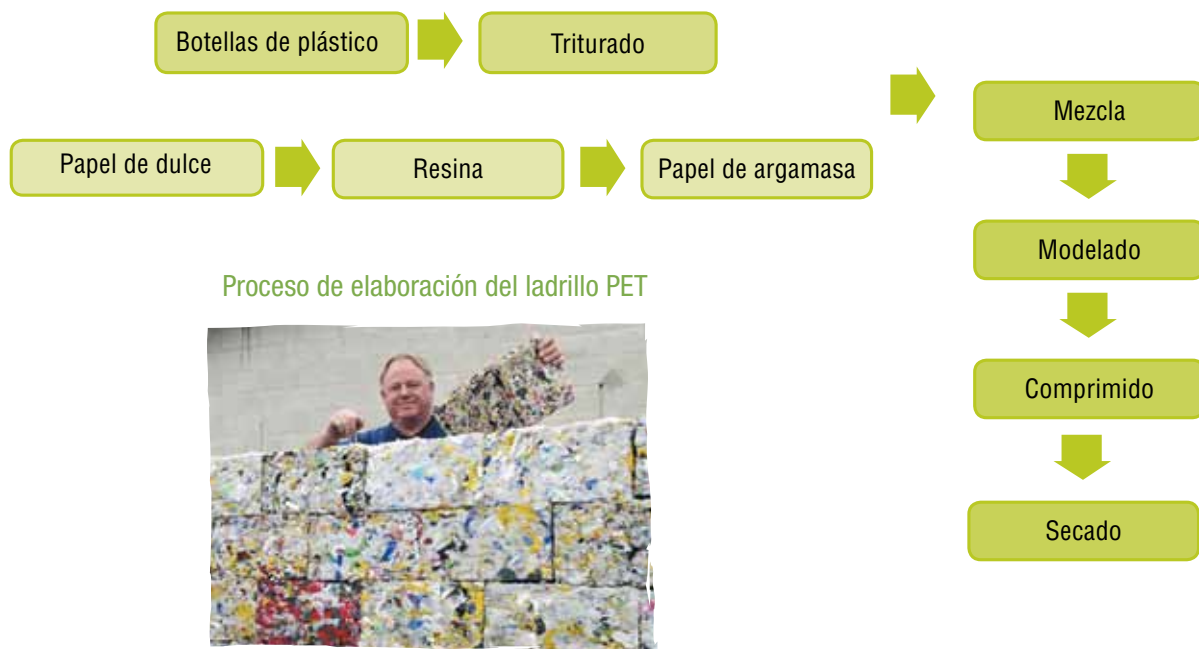
Gráfico 4. Proceso de producción de ladrillos PET
